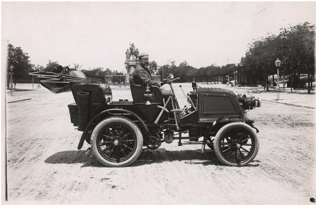
El Conde del valle en su auto-móvil “Daimler” de Cannstad (Alemania) del año 1900. Fotografía el año 1901 en la Castellana de Madrid. Motor Nº 1858-16 HP- 4 velocidades- 3 frenos independientes ( 2 con refrigeración por agua) encendido eléctrico de baja tensión con ruptores y magneto Bosch. **La afición del fotógrafo por los automóviles durará toda su vida.**
