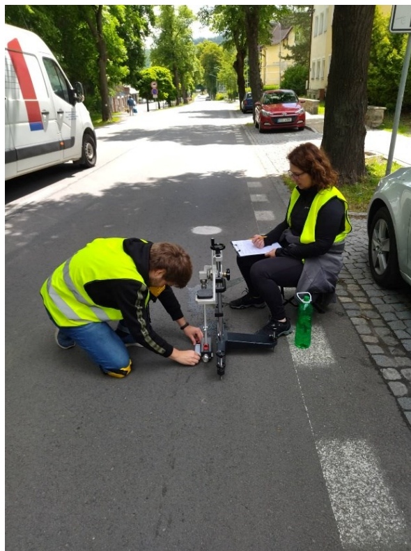
Obrázek 20 - měření PTV ve staničení 0,376
