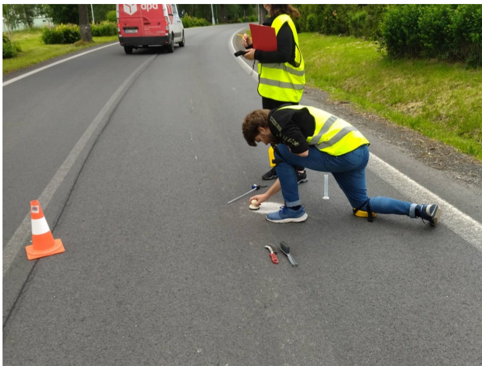
Obrázek 24- měření MTD ve staničení 0,489
