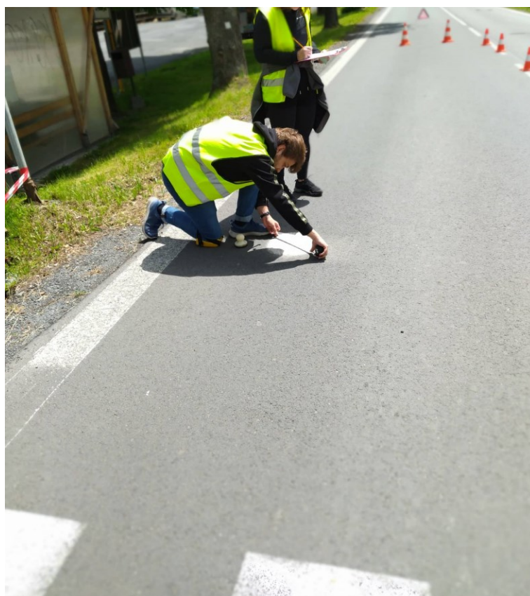
Obrázek 19- měření MTD ve staničení 0,489
