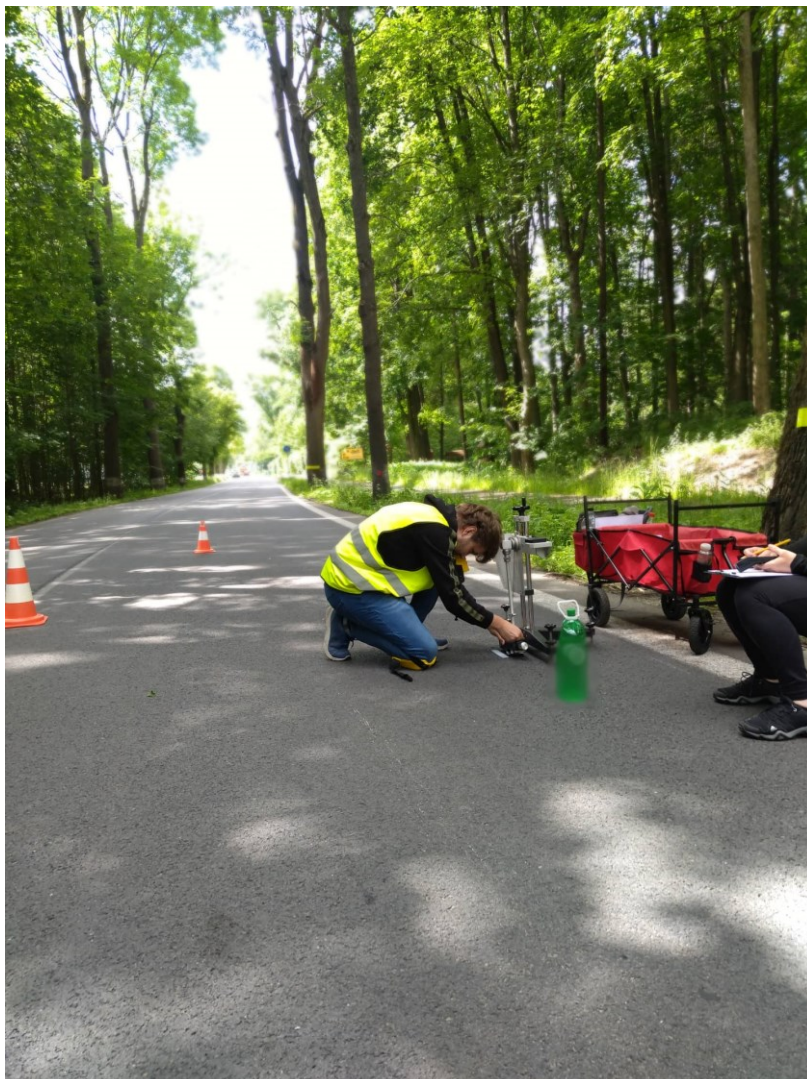
Obrázek 27 - měření PTV ve staničení 1,471
