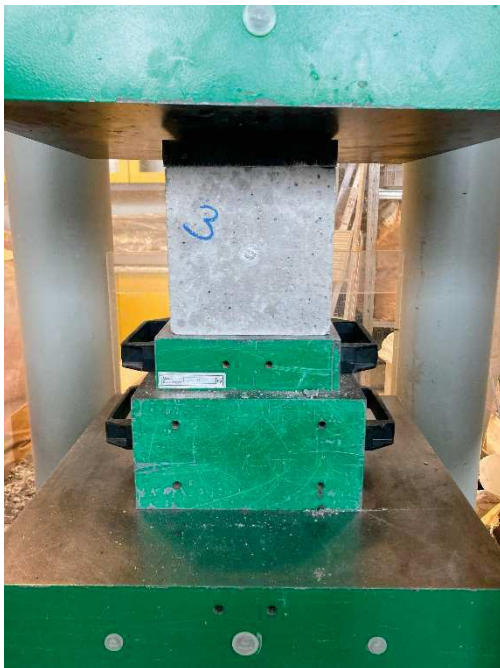
Obrázek 9 Krychle o hraně 150 mm připravená na zkoušku pevnosti v tlaku, zdroj: vlastní
