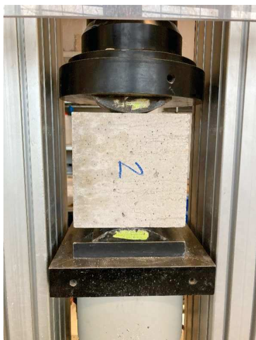
Obrázek 11 Krychle o hraně 150 mm připravená na zkoušku pevnosti v příčném tahu, zdroj: vlastní
