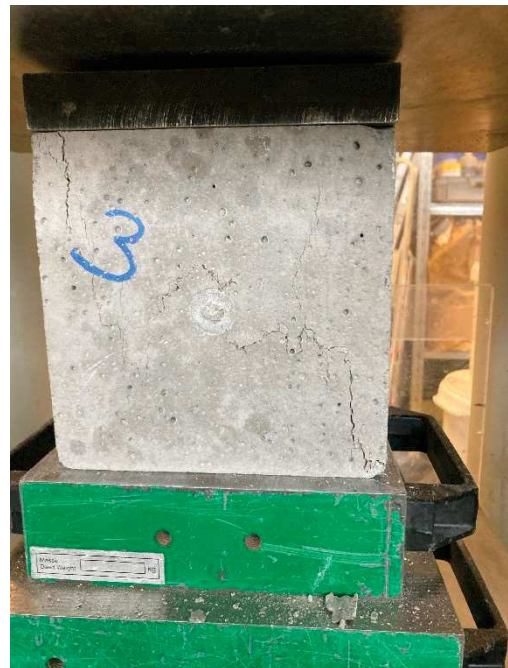
Obrázek 8 Krychle o hraně 150 mm po zkoušce pevnosti v tlaku, zdroj: vlastní
