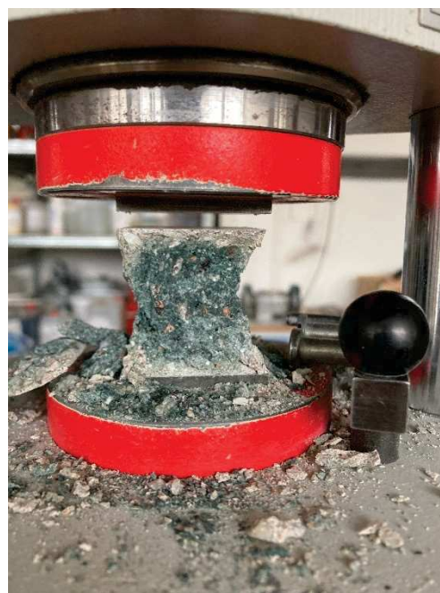
Obrázek 6 Typické porušení vzorku při zkoušce pevnosti v tlaku
