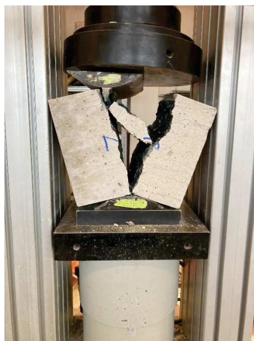
Obrázek 10 Krychle o hraně 150 mm po zkoušce pevnosti v příčném tahu, zdroj: vlastní
