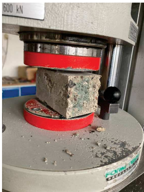
Obrázek 7 Polovina trámce připravená na zkoušku pevnosti v tlaku, zdroj: vlastní
