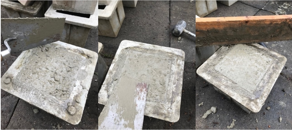
Obrázek 12 Úprava povrchu těles - 1 x uhlazení zednickou lžící, 3 x uhlazení zednickou lžící, klikatým tahem latí
