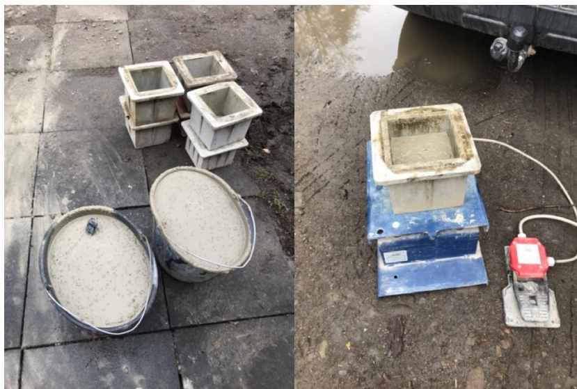
Obrázek 11 Odběr betonové směsi a výroba těles
