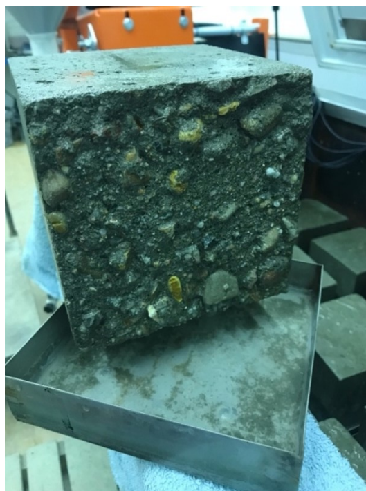
Obrázek 19 Výsledný povrch a slitý odpad po zkoušce CHRL
