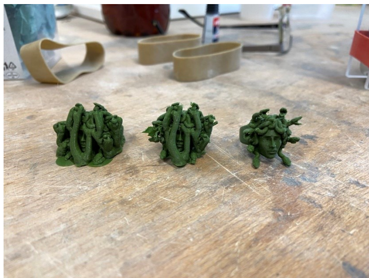
Obr. 19 Proces odstranění podpěr
