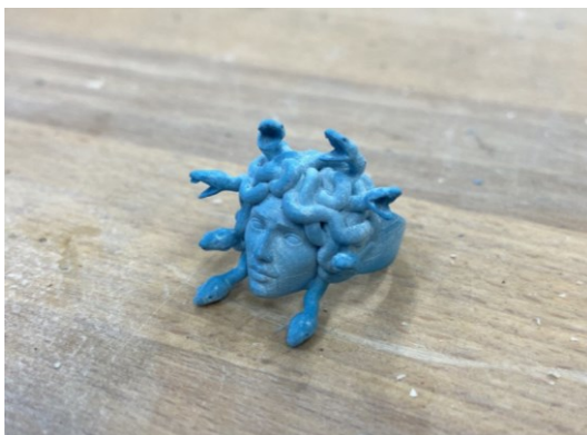
Obr. 41 Vytištěný voskový model
