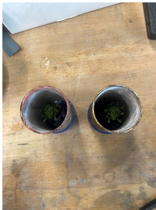
Obr. 23 Forma s modelem prstenu uvnitř
