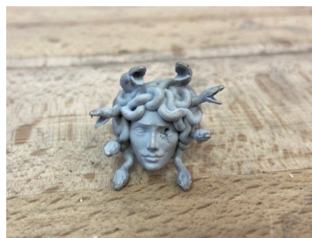
Obr. 44 Druhý finální odlitek s prasklinou
