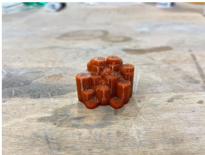
Obr. 39 Vytisknutý model prstenu s podpěrami
