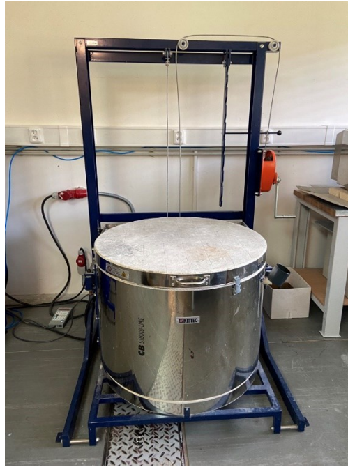
Obr. 26 Odporová pec využitá k žíhání
