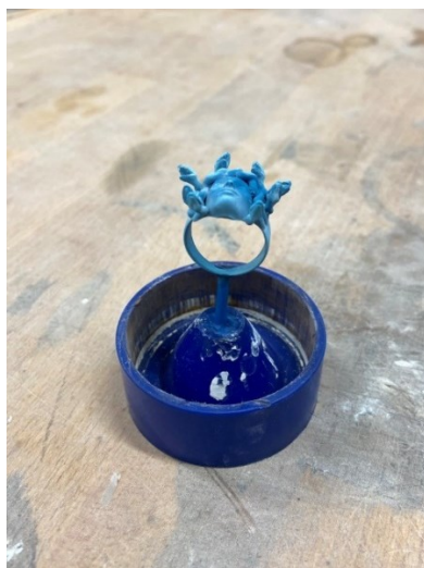
Obr. 43 Připravený voskový model s vtokovou soustavou
