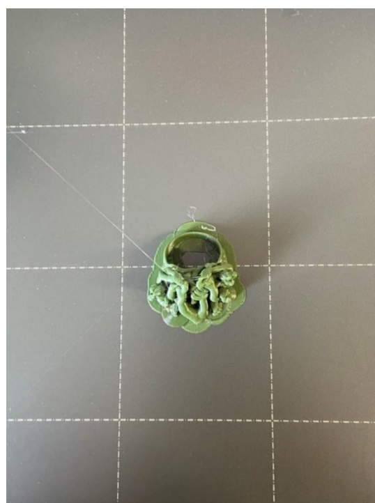
Obr. 18 Vytištěný model prstenu s podpěrami
