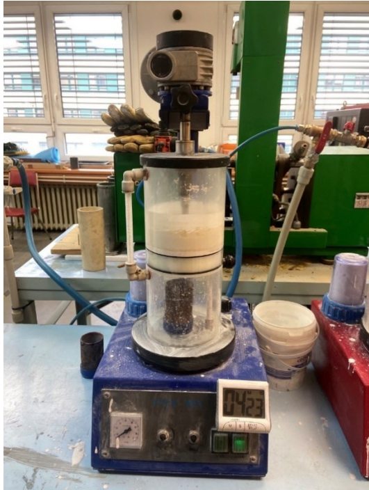
Obr. 24 Vakuový mísič Indu Mix
