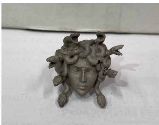
Obr. 35 Třetí zkušební stříbrný odlitek
