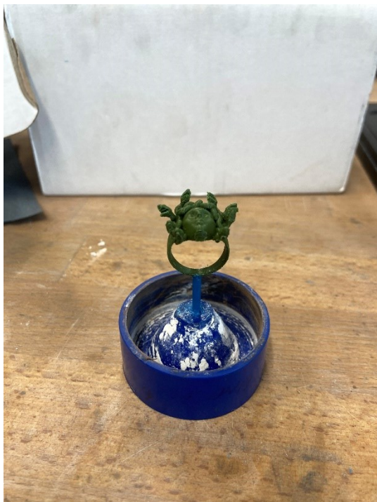
Obr. 22 Prsten připevněný ke vtokové soustavě a kloboučku
