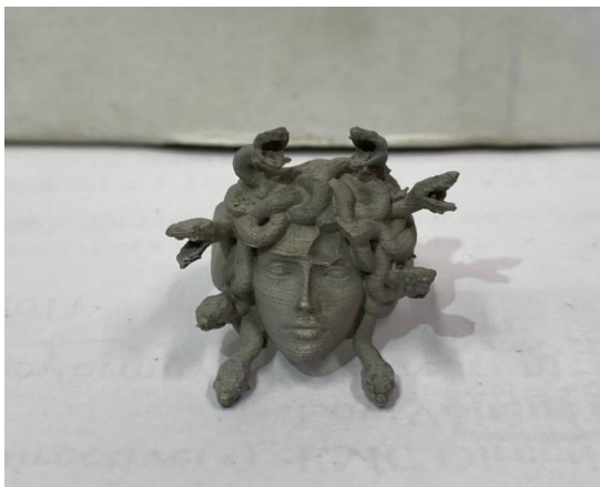
Obr. 34 Druhý zkušební stříbrný odlitek
