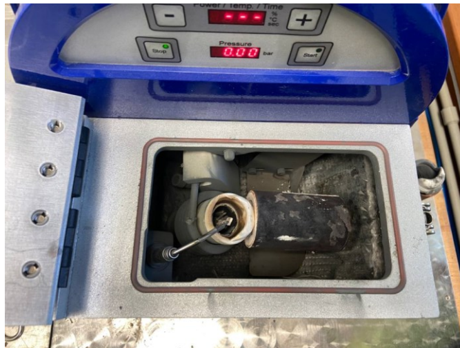
Obr. 27 Pracovní komora odlévacího a tavicího zařízení Indutherm MC15
