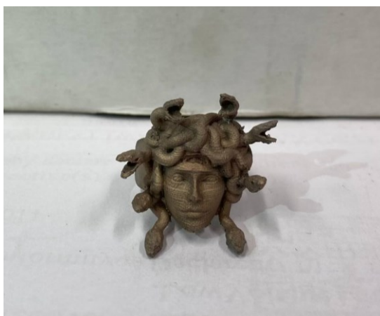
Obr. 32 Zkušební bronzový odlitek po úpravě návrhu modelu
