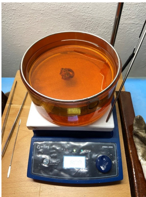
Obr. 40 Proces loužení v rozpouštědle podpůrného vosku ADV100 pro Solidscape
