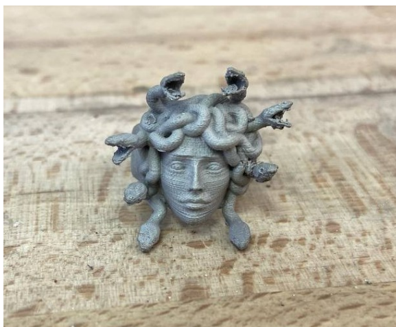
Obr. 36 Zkušební stříbrný odlitek bez staženin
