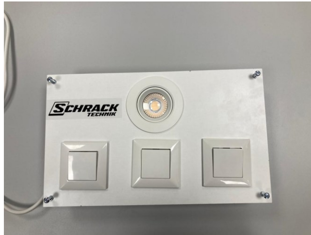
Obr. 24 Panel schodišťového vypínače
