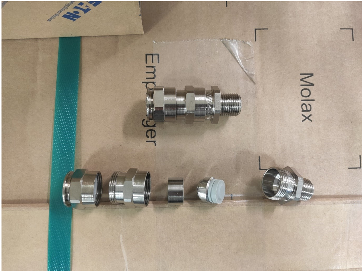
Pohled na rozloženou armovanou kabelovou průchodku pro projekt AC-4057
