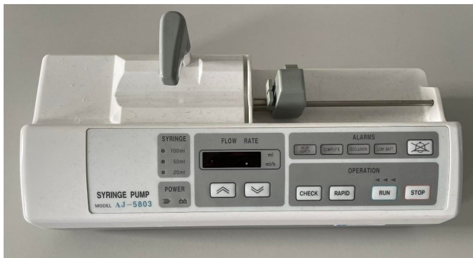
Obr. 2.3: Lineární dávkovač AJ 5803 ANGEL.
