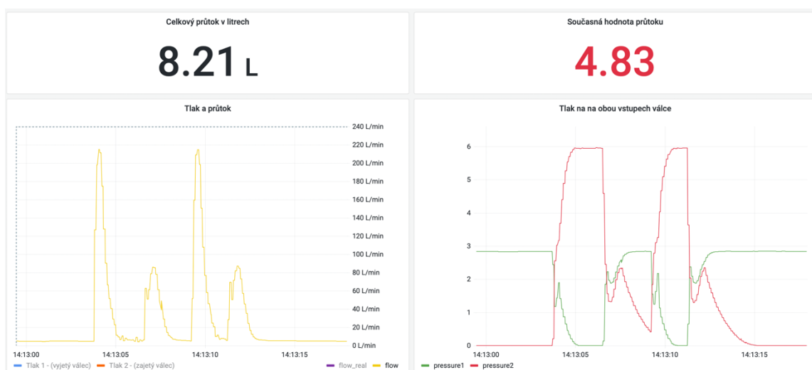
Obrázek 56 : Výsledek s jiným typem válce se sníženým tlakem
