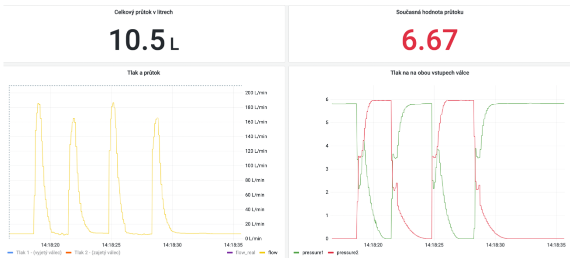
Obrázek 55 : Výsledek s jiným typem válce pro konstantní tlak 6 bar
