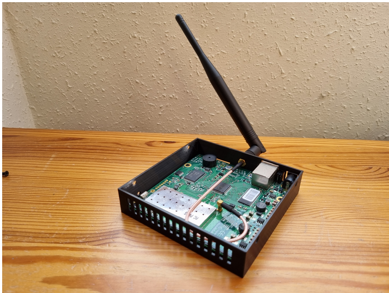
Obrázek 2.5: Zařízení pro zachytávání ITS zpráv
