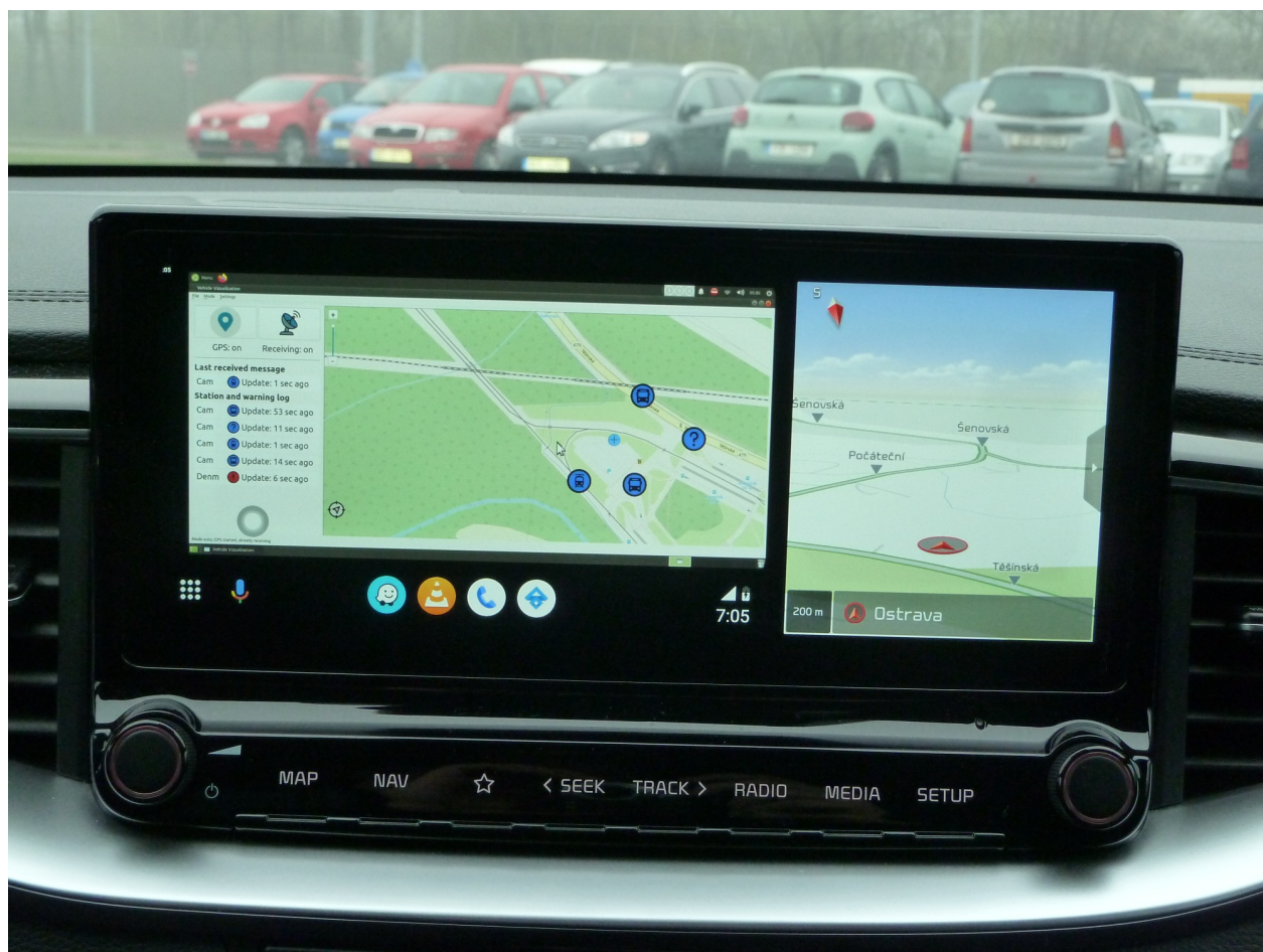
Obrázek 6.1: Bližší pohled na infotainment ve vozidle Kia XCeed s otevřenou vizualizační aplikací (vlevo) a s otevřenou navigací (vpravo) v okolí terminálu Hranečník v Ostravě
