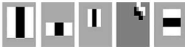
Obrázek 2.1: Ukázka prvních 5 příznaků typu Haar z publikace Detecting Pedestrians Using Patterns of Motion and Appearance [7]
