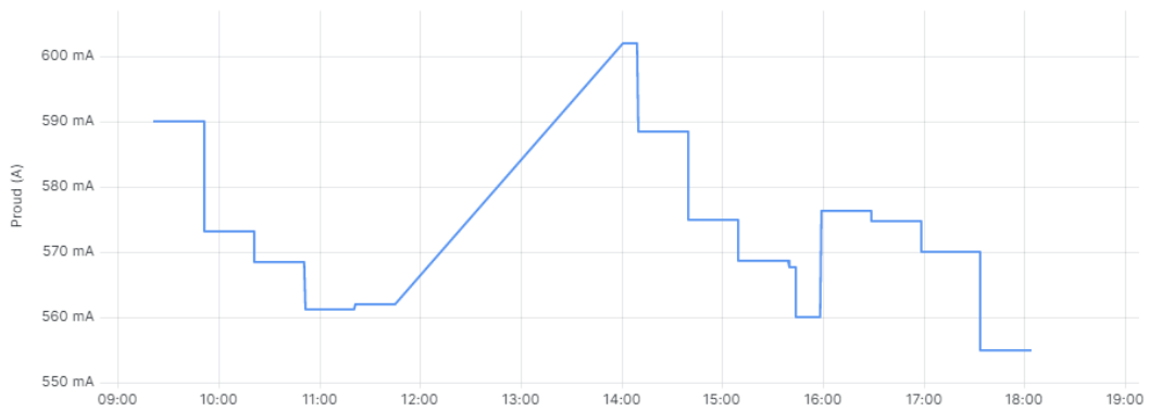
Obrázek 68 – Vliv zátěže na průměrnou hodnotu měřeného průběhu proudu 1. osy robotu
