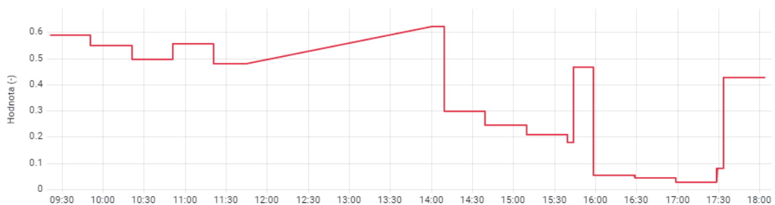
Obrázek 63 – Vliv zátěže na koeficient špičatosti průběhu proudu 2. osy robotu
