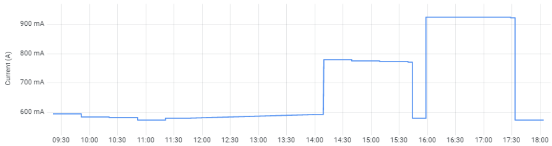
Obrázek 61 – Vliv zátěže na medián průběhu proudu 2. osy robotu
