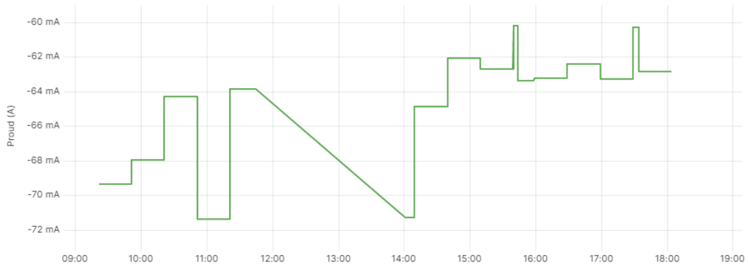
Obrázek 67 – Vliv zátěže na průměrnou hodnotu OPC průběhu proudu 1. osy robotu
