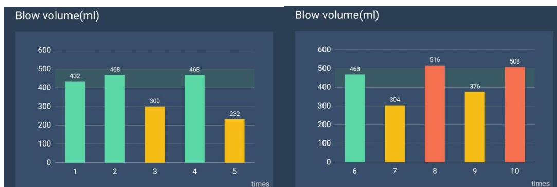
Obrázek 6.9: Snímky z aplikace CPR Trainer – objem výdechů při nácviku KPR Pozn.: obdobně i zde jsou zelenou barvou značeny dostatečné objemy vzduchu, žlutě objemy nedostatečné a červeně objemy příliš velké. Rovněž i v Obr.6.9 je vyznačen pás adekvátních hodnot mezi 400 a 500 ml. (16)
