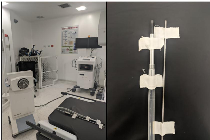
**Figura 3-2.:** Montaje experimental para la verificación del tiempo de tránsito. Se muestra el tandem que a su vez esta conectado al tubo de tranferencia y este al robot.
