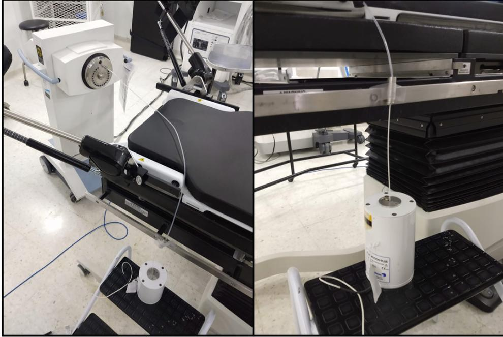
**Figura 3-1.:** Montaje experimental para la verificación de la actividad de la fuente. En la imagen se muestra el robot GammaMed Plus iX, la cámara de pozo que esta conectada al robot mediante un tubo de tranferencia por donde va la fuente y esta a su vez conectada a un electrómetro para medir las cargas colectadas. Se sujeta el tubo de tranferencia a la camilla con el fin de que este llegue de manera perpendicular a la cámara y evitar posibles obstrucciones de la fuente.
