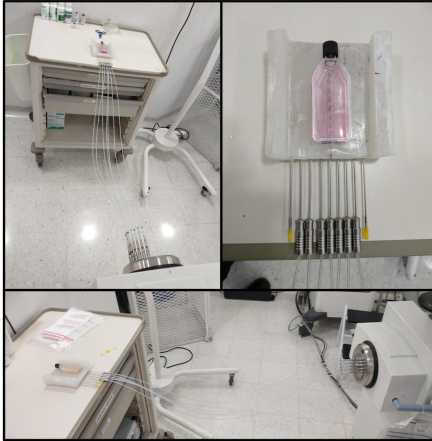
**Figura 4-7.:** Montaje experimental utilizado para la irradiación de los cultivos celulares. En la imagen se ve el robot Gamma Med Plus iX que contiene la fuente, los tubos de transferencia, las agujas por donde pasa la fuente y la parafina utilizada para sostener las agujas y el matraz
