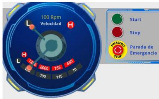
Ilustración 29 Seleccionador de Caja de Velocidades, inicio y paros de las revoluciones por min.
