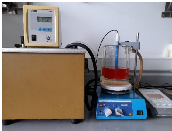
Figura 2.2 . Montaje para la oxidación catalítica del colorante rojo allura empleando el sistema BAP.
