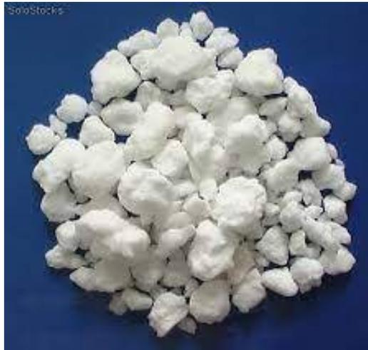
La dosis del cloruro de calcio es 1-2% en función a la masa de suelo seco. La mezcla, el compactado y el acabado son parecidos al estabilizar con cloruro de sodio; por lo general el cloruro se disuelve en agua por riego al inicio de la estación seca (31).
