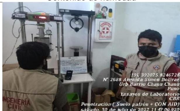
**Foto 5: CBR Ensayo de Penetración**
