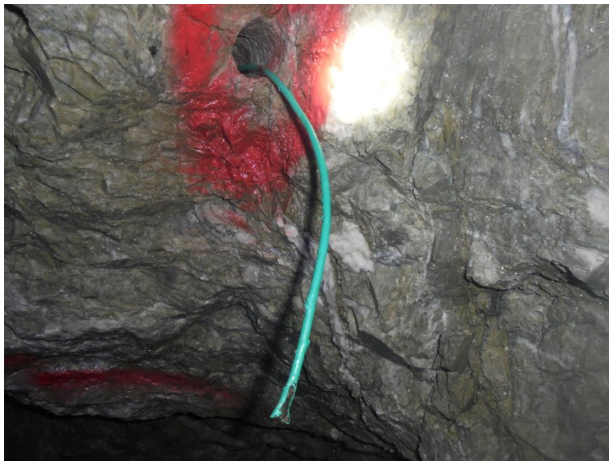
Figura 16. Escenario actual – tiro cortado de la galería 2450 Tomada del área de Operaciones de la Cía. Minera Poderosa S. A.
