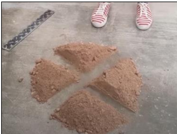
Figura 51. Procedimiento del cuarteo para iniciar el análisis granulométrico.
