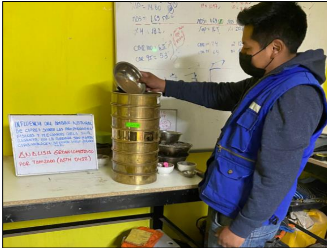
Figura 52. Material es pasado por diferentes tamices.
