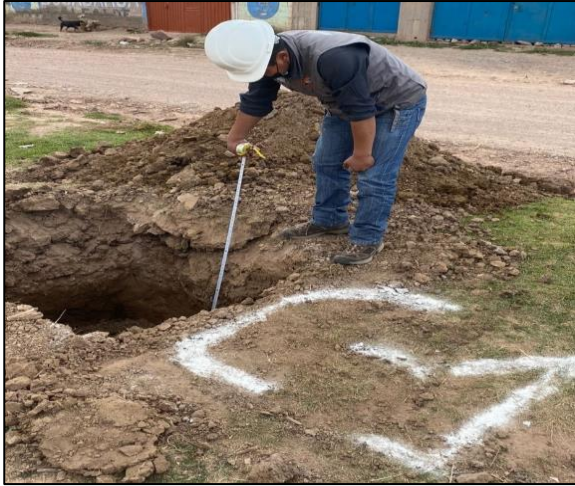
Figura 47. Determinando la profundidad de la calicata 1.
