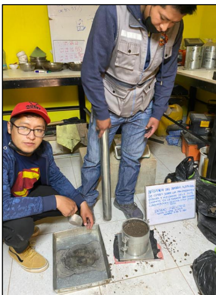
Figura 75. Culminando con la compactación.
