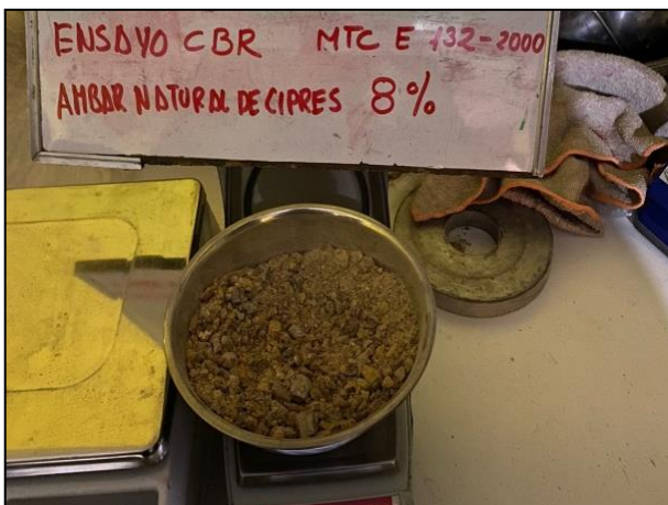
Figura 79. Ámbarr al 8 % para el ensayo de CBR.
