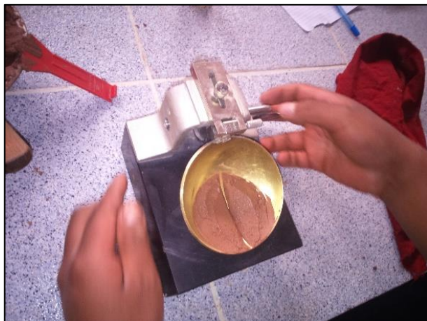
Figura 58. La ranura se cierra con menos de 25 golpes.
