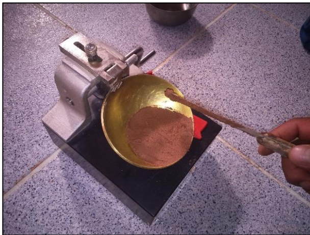
Figura 57. Con la espátula misma formar un surco en la pasta.
