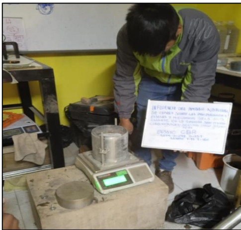
Figura 81. Lectura de peso del molde y de la muestra para la prueba de CBR.
