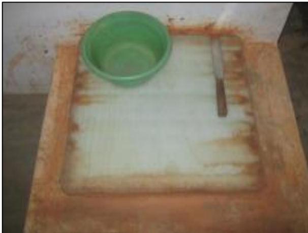
Figura 17. Equipo de límite plástico. Fuente: Junco y Tejeda (47), p. 801.
