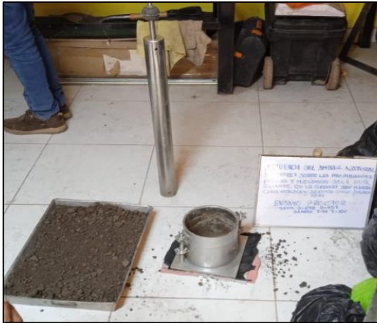
Figura 73. Inicio de compactación con el ensayo de Proctor.
