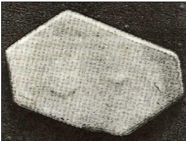
Figura 9. Forma de las partículas de arcilla. Fuente: Alvarado y Baquero (34), p. 4.
