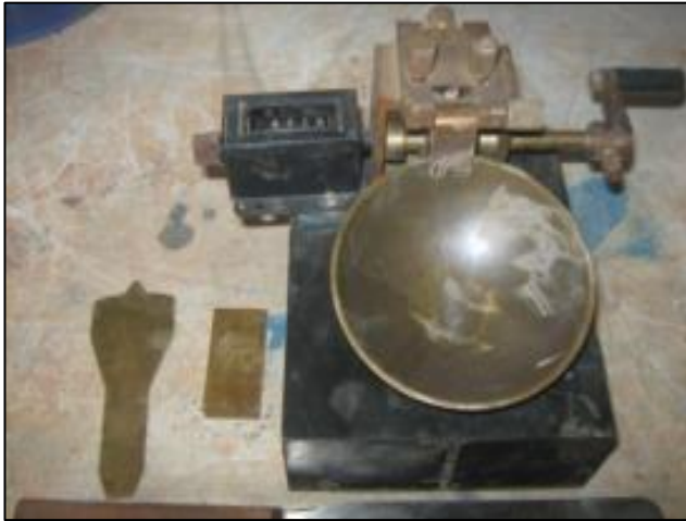
Figura 16. Cuchara de casagrande. Fuente: Geotecnia Fácil (46).
