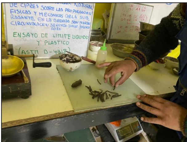
Figura 62. Se gira y se rola en una placa de vidrio las barritas.
