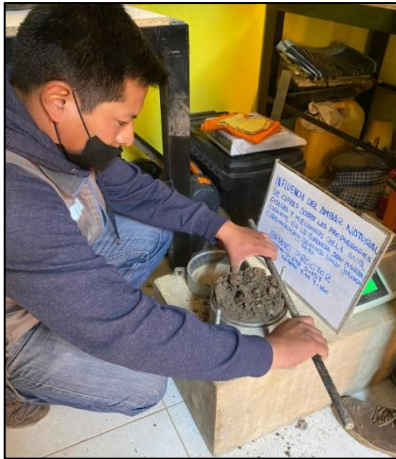
Figura 76. Rasado de la muestra excedente.
