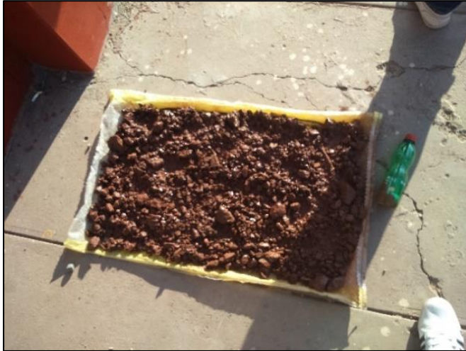
Figura 50. Secado de muestras antes de su ingreso a laboratorio.
