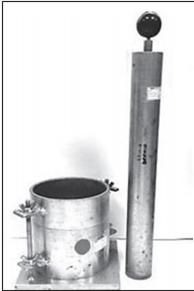
Figura 22. Elementos del sistema de compactación Proctor. Fuente: Cordero (54), p. 188.
