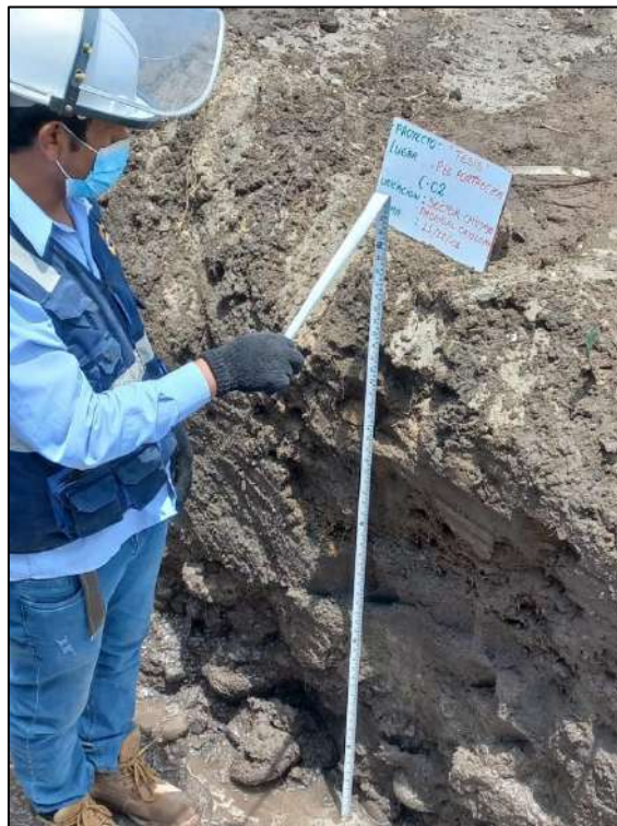
Foto 4. Vista de la excavación de la calicata 2 con una profundidad de 1.80 m
