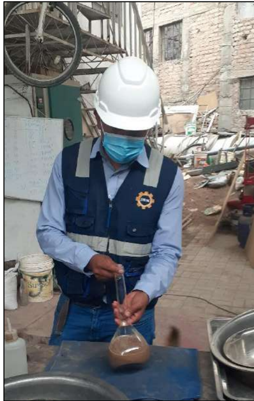
Foto 7. Vista del ensayo del peso específico
