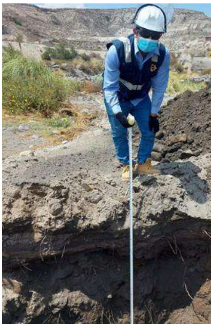
Figura 20. Excavación de la calicata 02– Prof.=1.80 m en el tramo 0+00 – 025+60.
