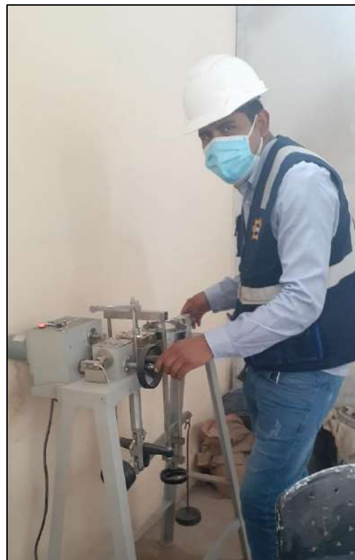
Foto 8. Vista del ensayo de corte directo.
