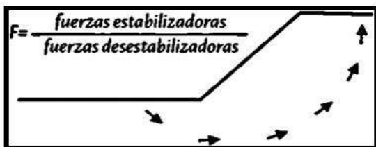
Figura 10. Esquema estabilidad de talud.
