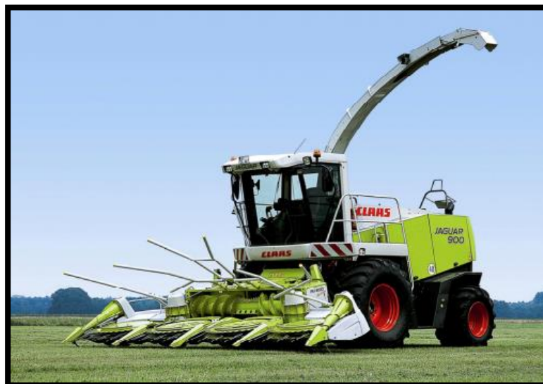
Figura 5. Los cabezales no direccionales, pueden utilizarse en cultivos en hilera, pero no requieren un desplazamiento por esta (10)
