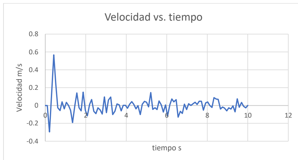
Figura 69. Valores de la velocidad de las partículas impulsadas por las cuchillas empleando el software EDEM (velocidad vs. tiempo)
