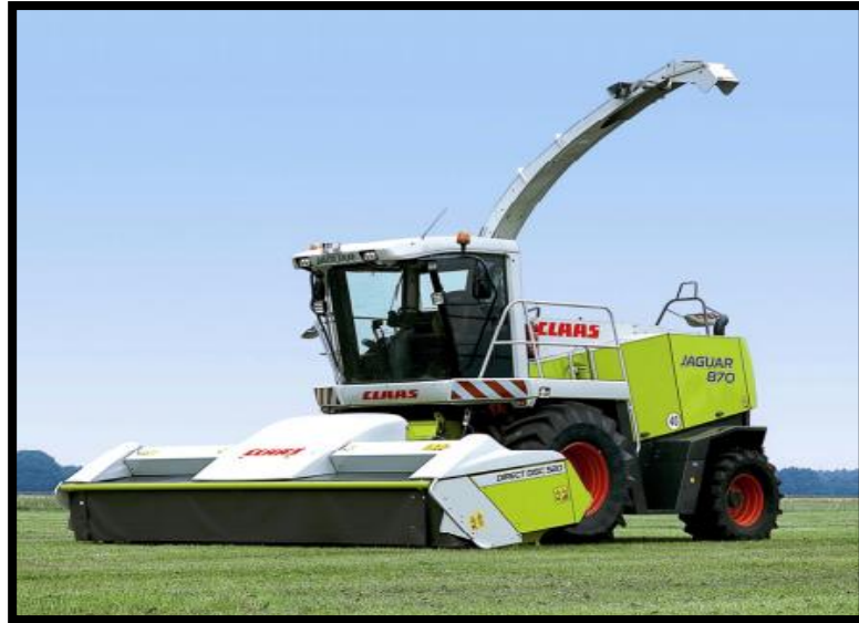
Figura 6. Los cabezales de corte directo son para cosechar cultivos en pie, ya que resultan ser más eficiente al momento de ser seccionados (10)
