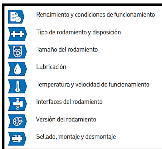
Figura 11. Independientemente de la vida útil estimada del rodamiento, hay elementos clave que deben tenerse en cuenta a la hora de determinar los rodamientos para una aplicación Fuente: adaptada de https://n9.cl/ujh2q
