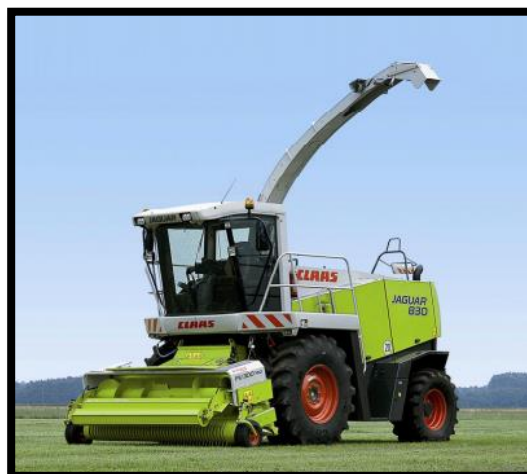
Figura 3. Existen varios tipos de cabezales para las cosechadoras de corte de precisión. Los cabezales de recogida sirven para cortar el heno que se ha dejado secar parcialmente en las hileras.
