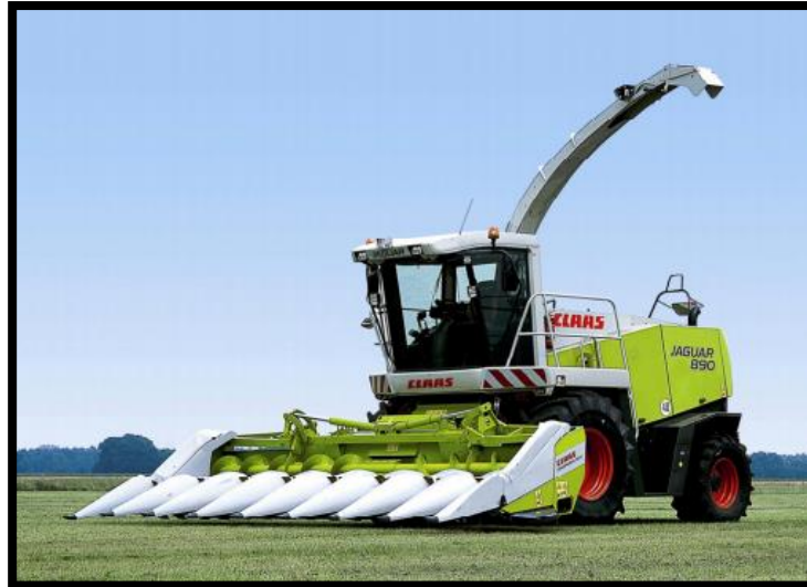
Figura 4. Los cabezales para cultivos en hileras se utilizan cuando hay que picar maíz u otros cultivos en hileras. Las hoces de los antiguos cabezales para cultivos en hilera han dado paso a un par de discos de corte giratorios para cortar cada hilera (10)
