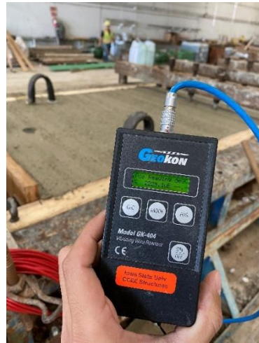
(d) Testing of the strain gauges
