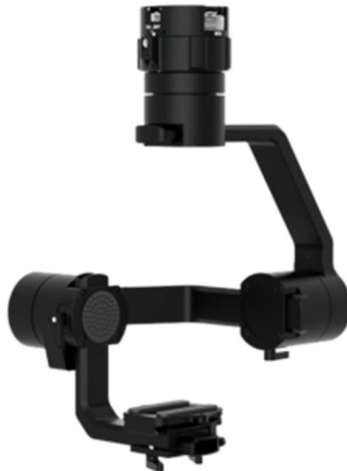
Figur 16: Eksempel på en gimbal, bildestabilisator (Gremesy).
