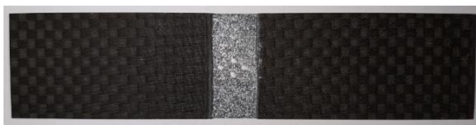
Figura 3.12 – Preparação das amostras a serem ensaiadas com o DIC ( Speckle aleatório).
