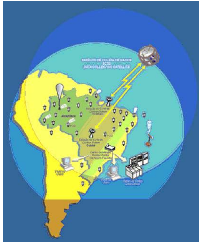
Figura 3.13 - Sistema Brasileiro de Coleta de Dados Ambientais SCD Fonte: (YAMAGUTI et al., 2006)
