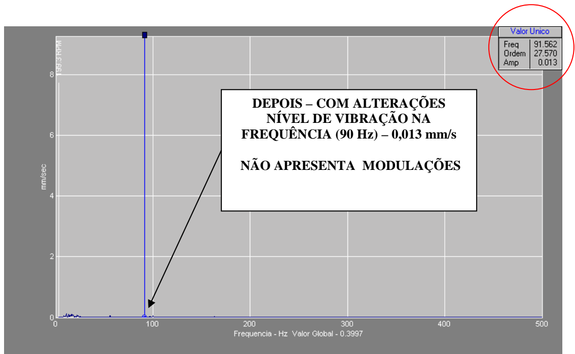
Figura 19. Espectro de vibração em velocidade depois das alterações
