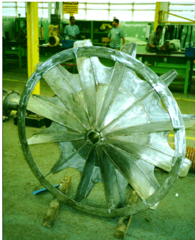
Figura 2.19 - Anel travando as pás do rotor
