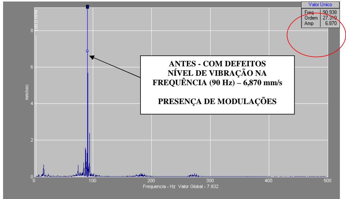
Figura 2.35 - Espectro de vibração em velocidade antes das alterações (rolos facetados)
