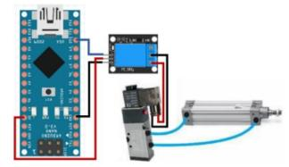
Fig. 12. Pneumatic pin circuits
