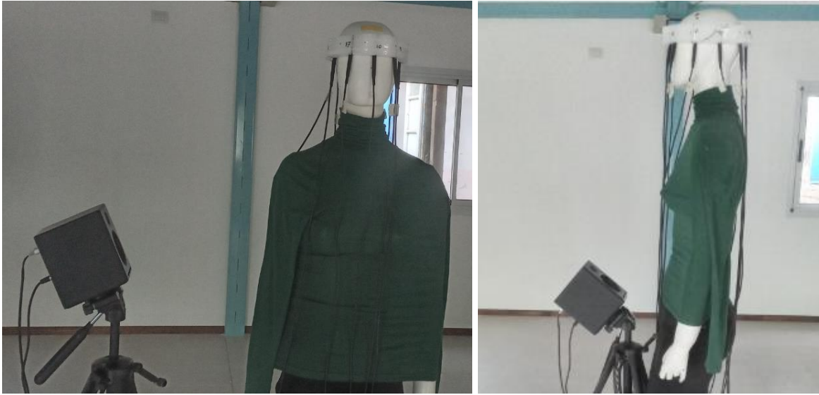
Figura 19. Puesta de parlante para Theta 120° (izq.) y 150° (der)
