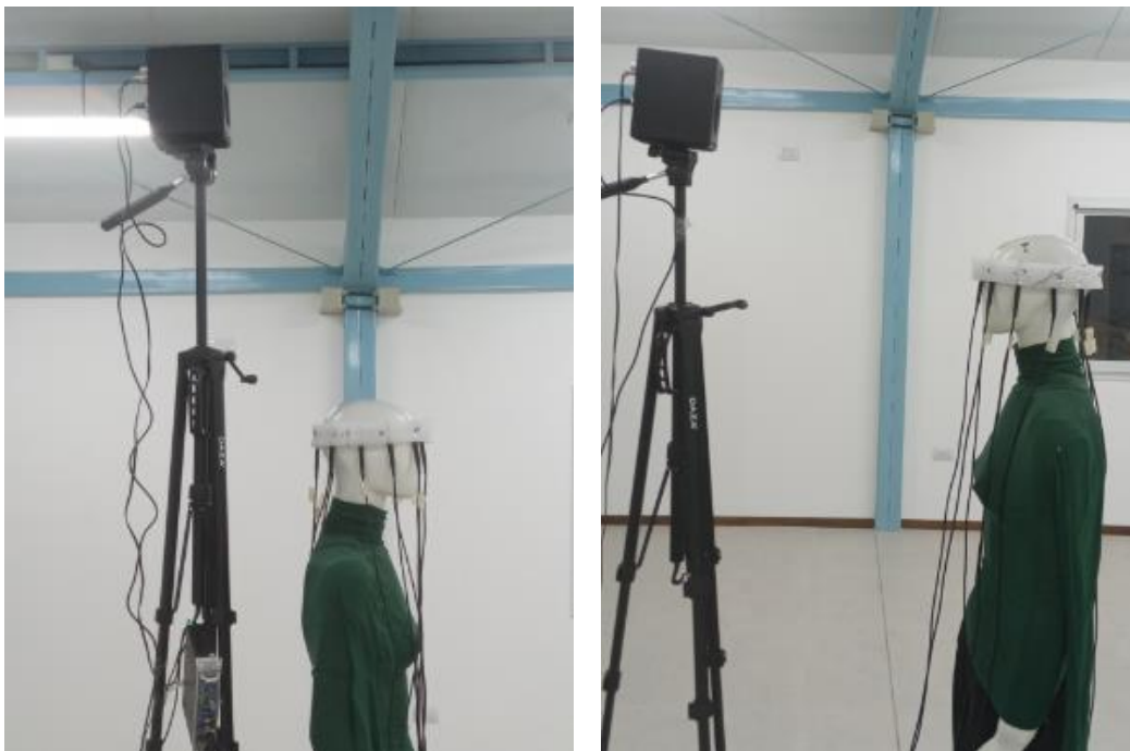
Figura 18. Puesta de parlante para Theta 30° (izq.) y 60° (der)
