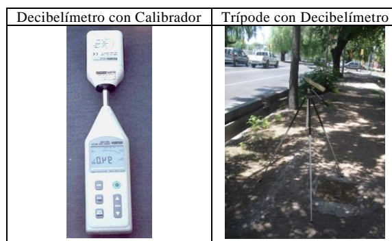
Figura 3. Equipos de medición sonora.
