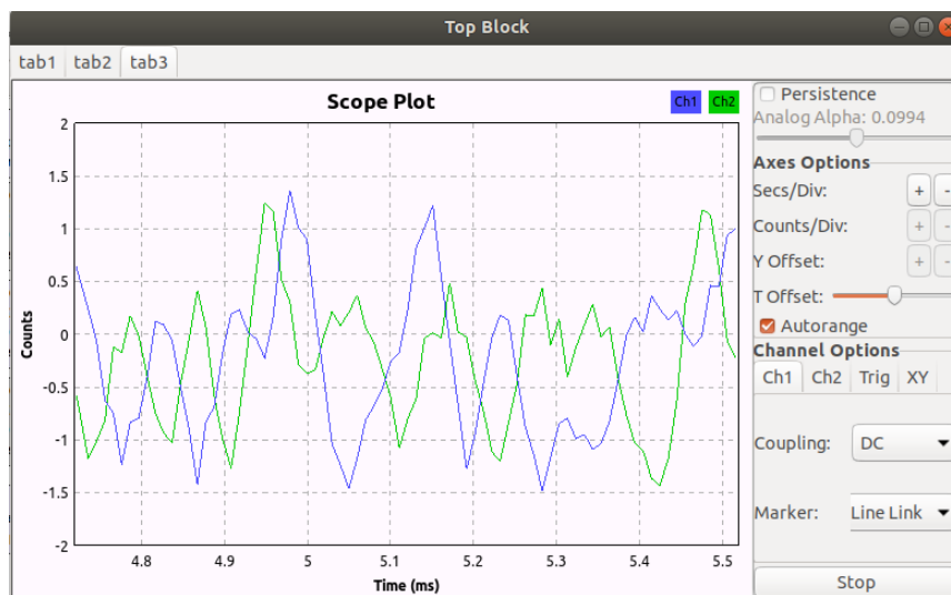
Рисунок 3.20 – форма сигналу у часовій області на вході фільтра нижніх частот
