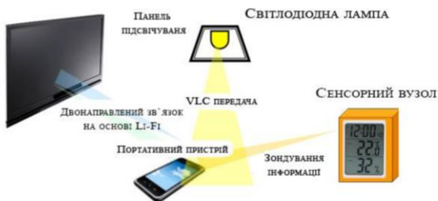
Рисунок 1.1 – Архітектура мережі VLC
