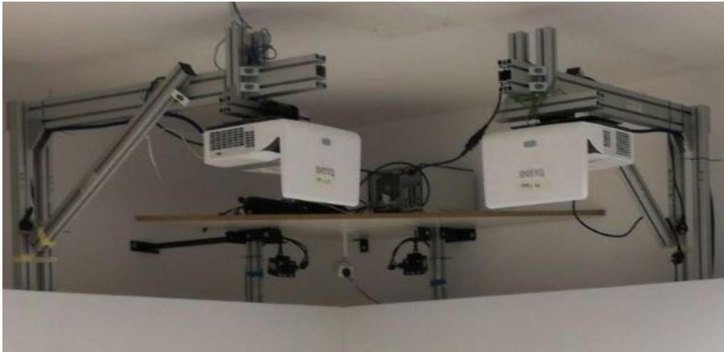
FIGURA 4.1.1.2 – VISTA FRONTALE DELL’INSTALLAZIONE DEI VIDEOPROIETTORI DELLA VR-CAVE DI SWING:IT
