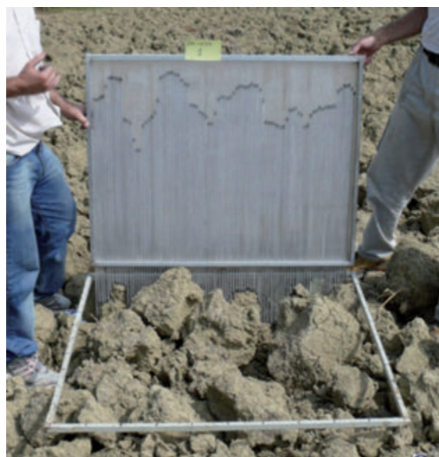
Figura 6. Rilievo dei profili superficiali con profilometro ad aghi.
