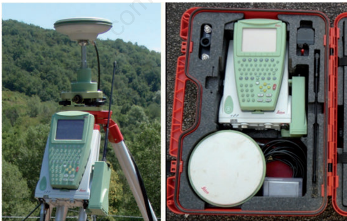
Figura 3. GPS Leika 1200 +GNSS montato su treppiedi in alluminio e a destra nella valigetta contenitore.
