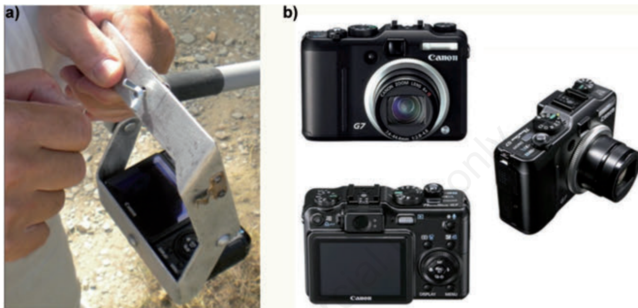
Figura 2. a) Supporto in alluminio presente all'estremità del palo. b) Fotocamera digitale Canon PowerShotG.
