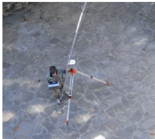
Figura 30. Treppiede realizzato come appoggio per il palo.
