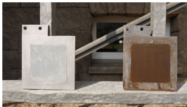
Abb. 3: Dachdeckerblei-Anode und Aluminium-Kathode nach der Elektrolyse
