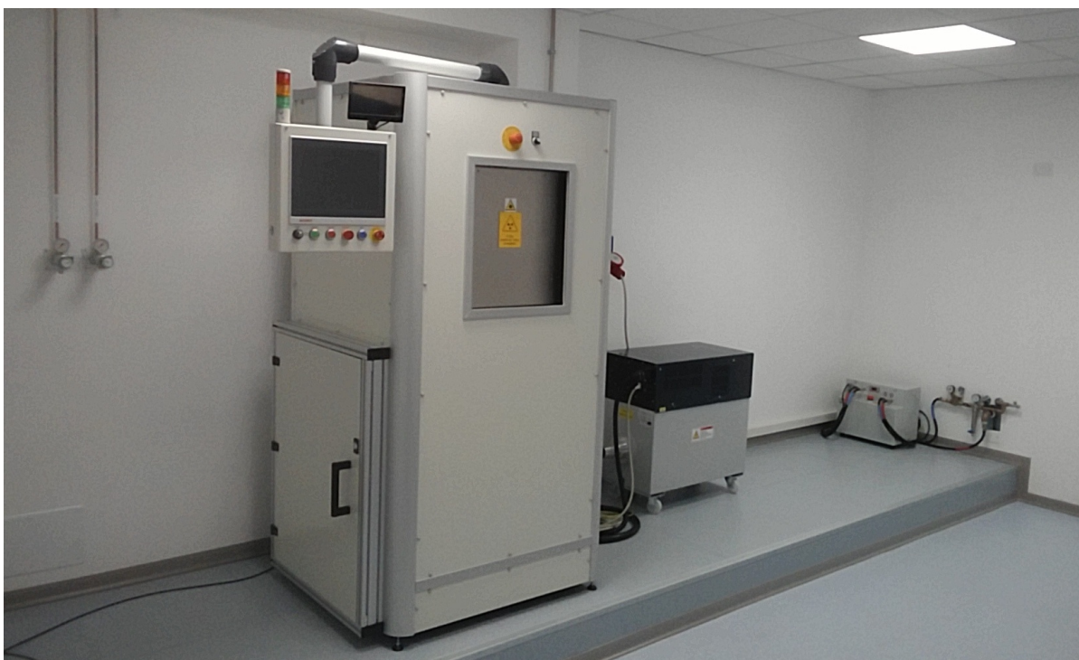
Figura 5: L'irraggiatore X del TIFPA con i suoi apparati di servizio.
