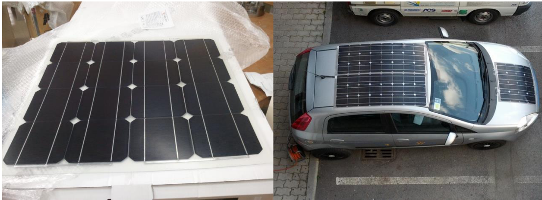
Fig. 7. (a). ENECOM HF65 PV panel. (b). Installation on FIAT Grande Punto.
