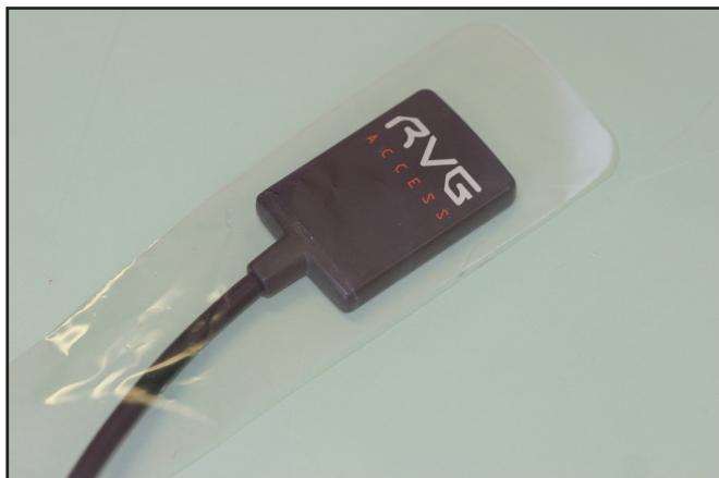
Fig. 4. Captador con funda desechable.
