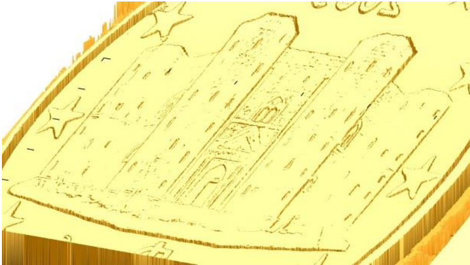
Figura 19: Dritto di moneta da 1 centesimo di euro con mesh da 5 \mu\text{m}
