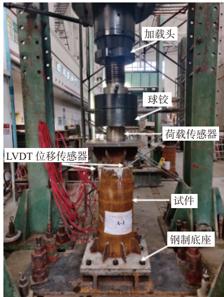
图 4 轴向静力加载装置示意图 Fig. 4 Axial static loading devices
