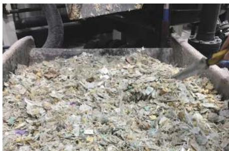
图4 风机叶片被拆分、切割、粉碎后用于水泥生产
