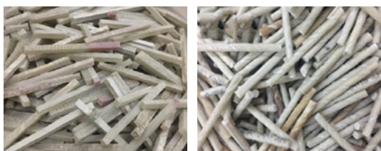
图 5 风机叶片切割加工成的针状元件
