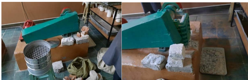
Рис. 1. Оборудование и материалы для дробления / Figure 1. Equipment and materials for crushing
