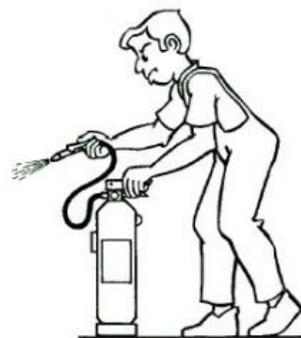
3. Presionar la palanca de la cabeza del extintor y en caso de que exista apretar la palanca de la boquilla realizando una pequeña descarga de comprobación.
