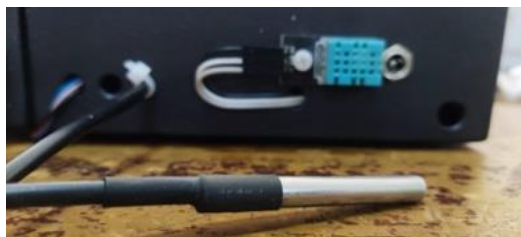
Gambar 12. Implementasi sensor suhu air DS18B20 ke ESP32
