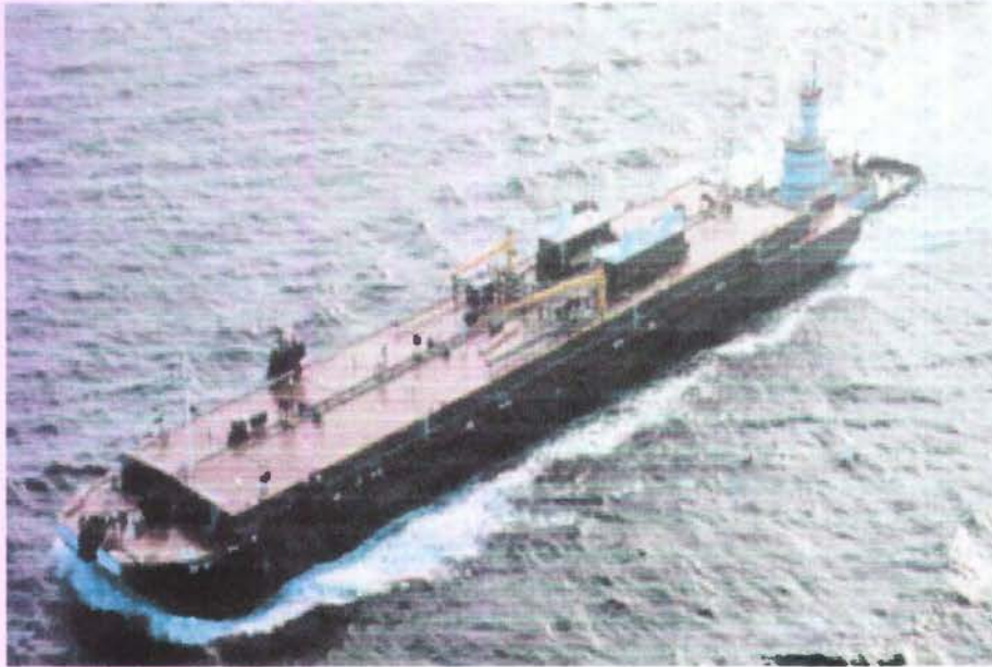
Gambar 2.10. Tanker Pusher-barge System untuk pelayaran samudra. Sumber: www.haig-brown.com , diambil: 4 Juni 2007.
