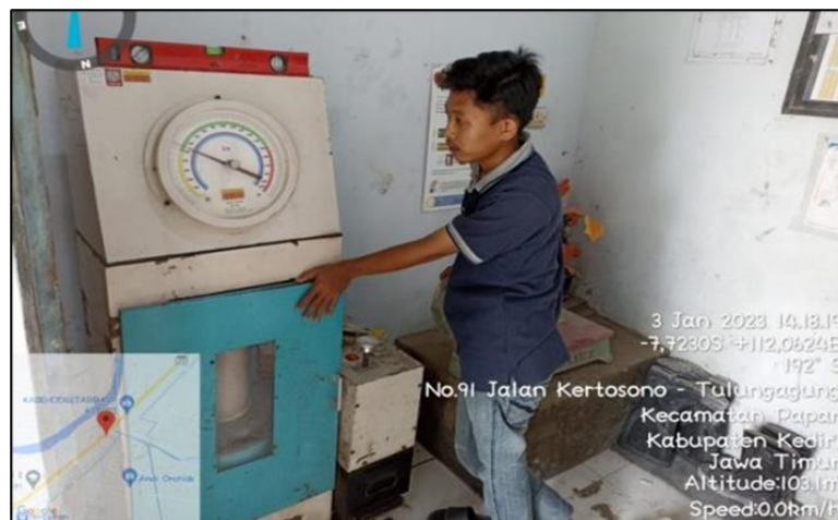
Gambar 2. 16 Pengujian Sampel Beton
