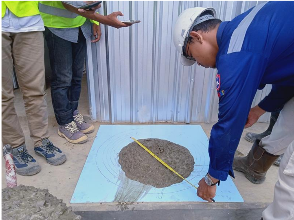
Gambar 4. 18 Pengujian Hasil SlumpFlow
