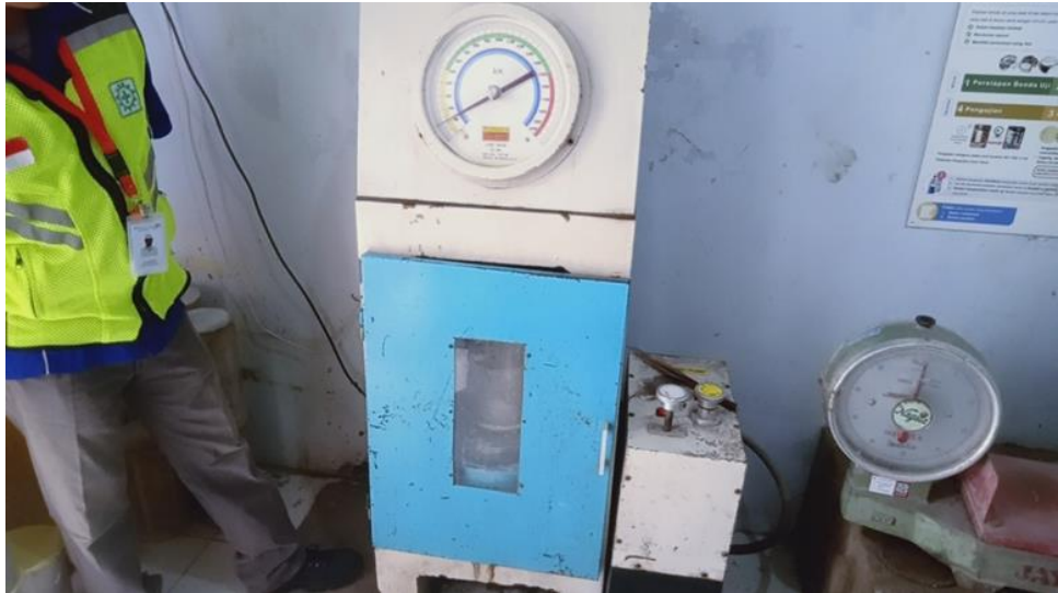
Gambar 4. 3 Pengujian Kuat Tekan Beton di Papar
