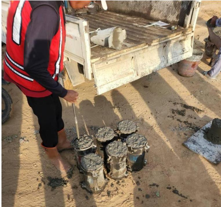
**Gambar 4.2** Persiapan 6 Sampel lapangan yang sudah di Slump Test
