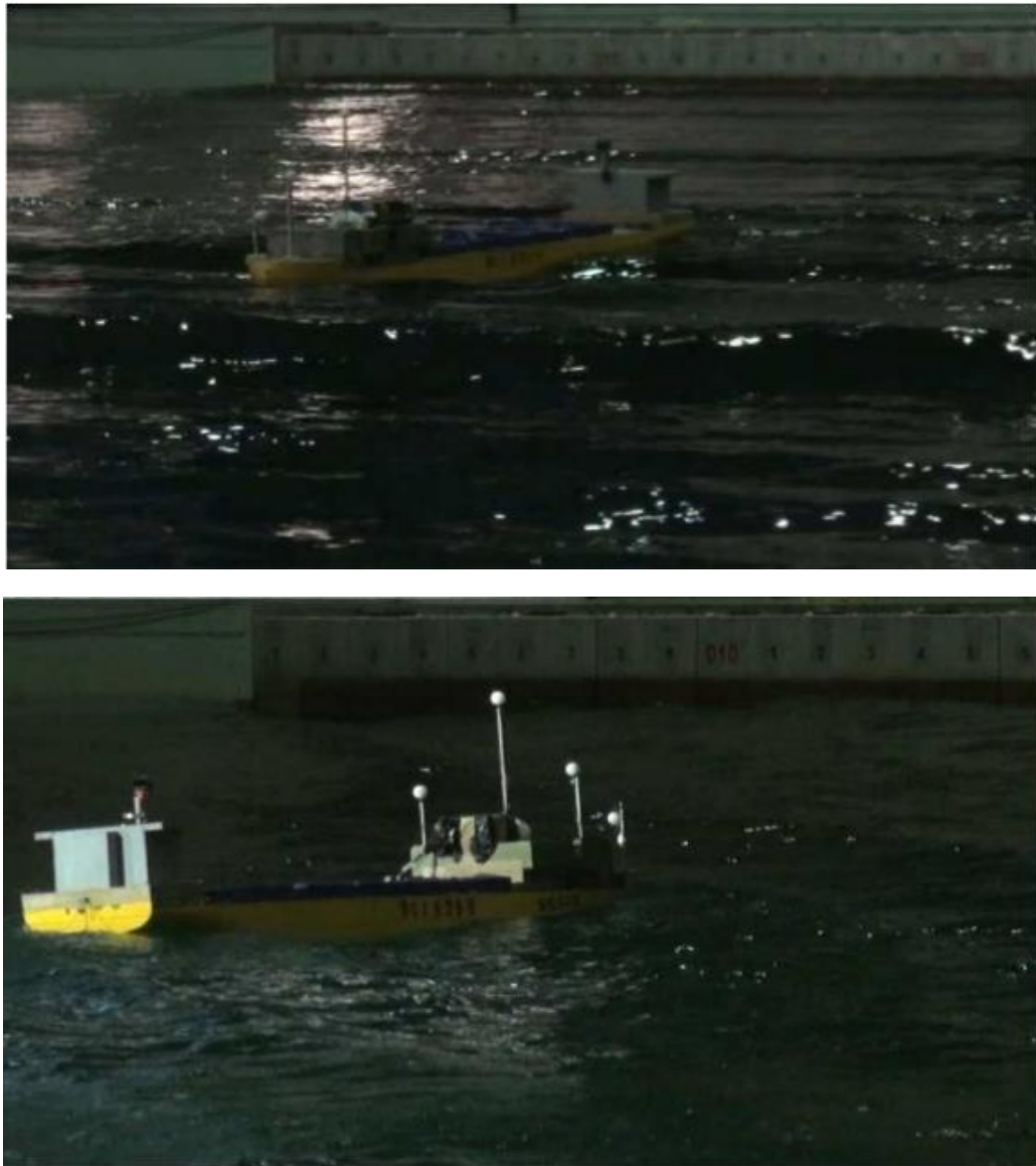
Gambar 3. 9 Towing test dengan sudut heading 0 derajat
