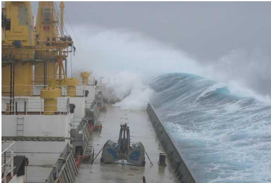
Gambar 2. 8 Deck wetness pada kapal
