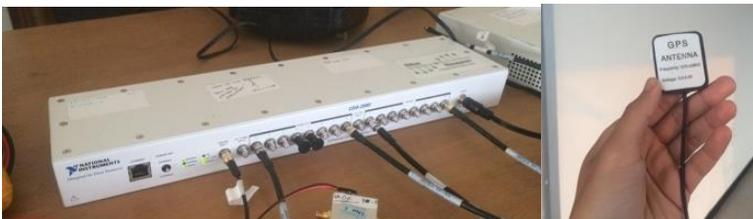
**Gambar 3.8** Perangkat *Octoclock* dan Antena GPS
