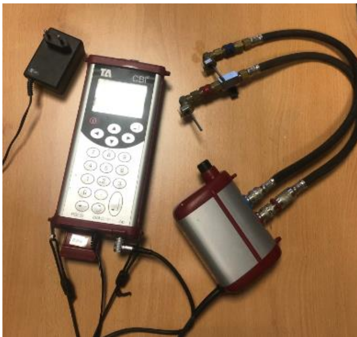
Figura 4.4 Dispositivo de medición de las válvulas TA.
