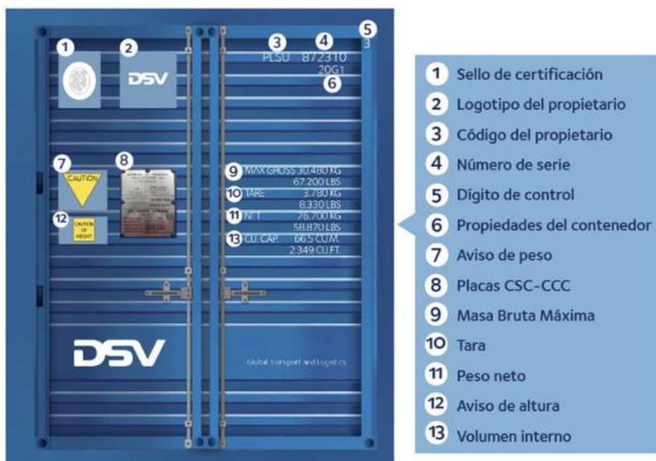
**Ilustración 9.5 Especificaciones técnicas contenedor [24]**
