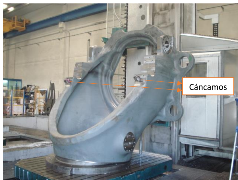
Fig.4.7 Colocación de la pieza en utillaje de subfase 2
