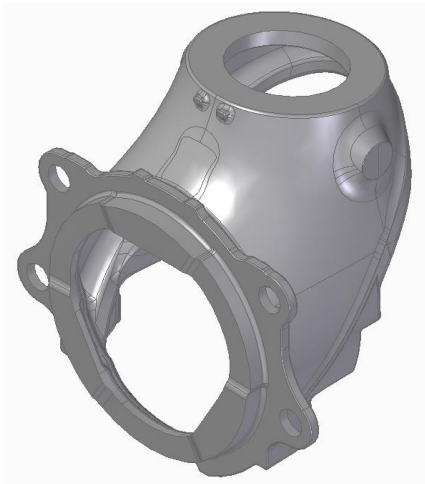
Fig.2.1 Preforma soporte eje de generador eólico
